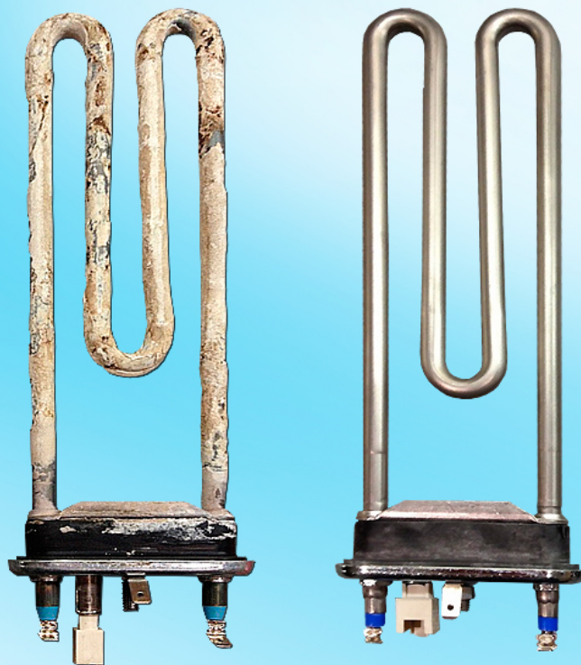
Слева - нагревательный элемент после 5 лет использования смягчителя "Calgon". Справа - для сравнения новый нагревательный элемент.
